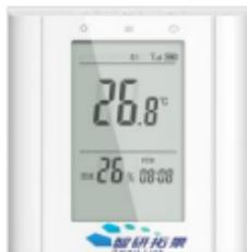
供电方式：2 节 ER14505 锂电池（可充电），电池容量 5400mAh
